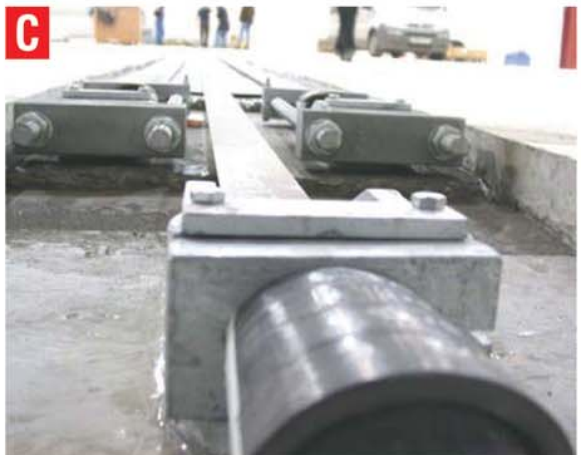
Базовый канал с предварительно напряженными углепластиковыми лентами
